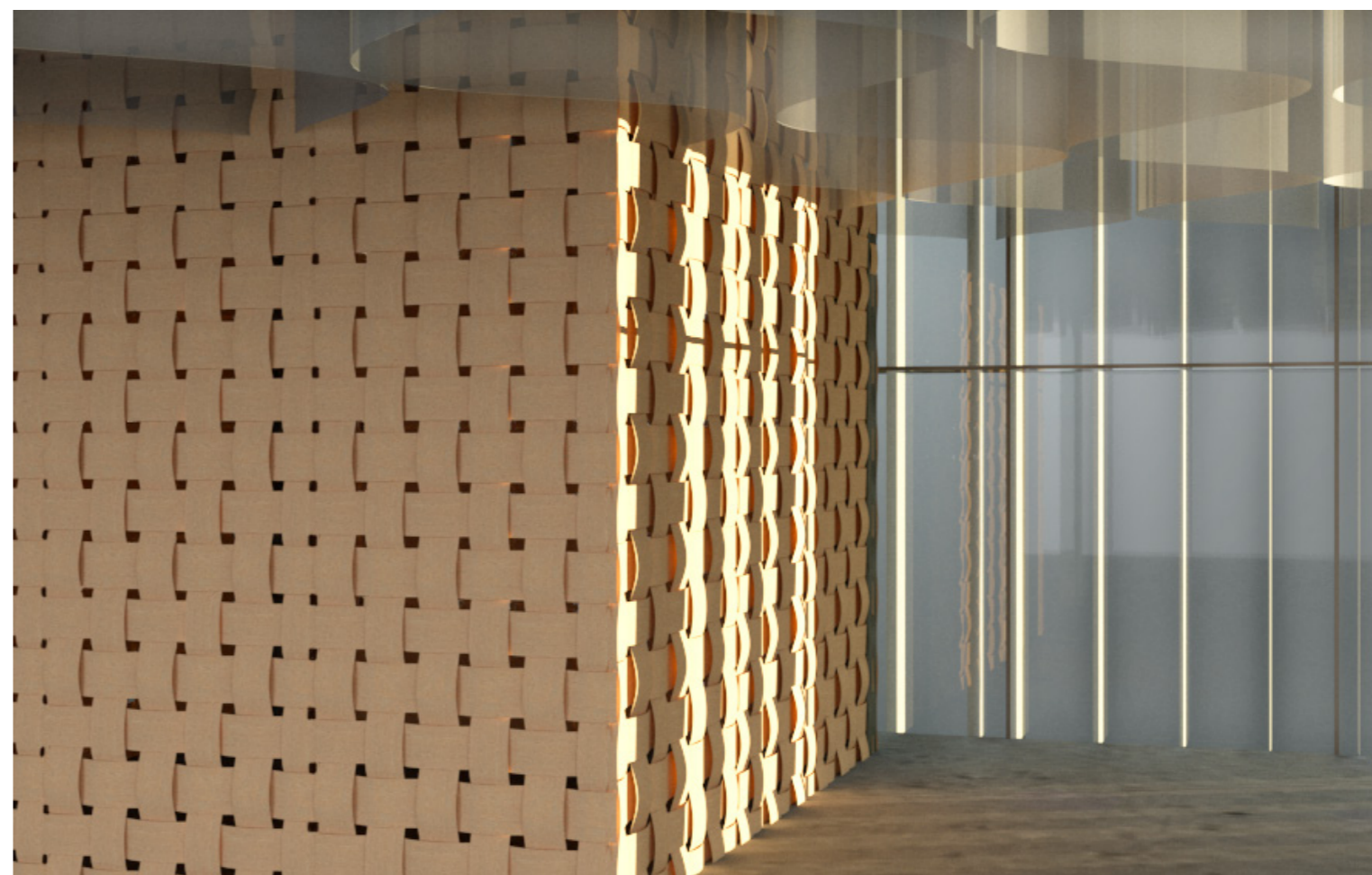
Rendering som visar hisschaktens beklädnad i form av vävt trä.
