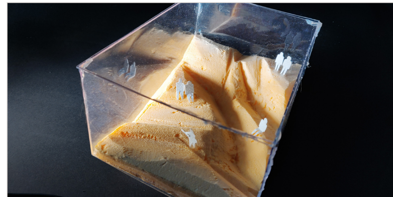
3. Spegelglas för att dölja hisschakten visade sig i modell fungera över förväntan, trots avsaknad av horisontella plan i den här modellen. 4. Konsertsalens geometri utforskas först i en fysisk modell, innan den tas in i datorn för akustikoptimering.
