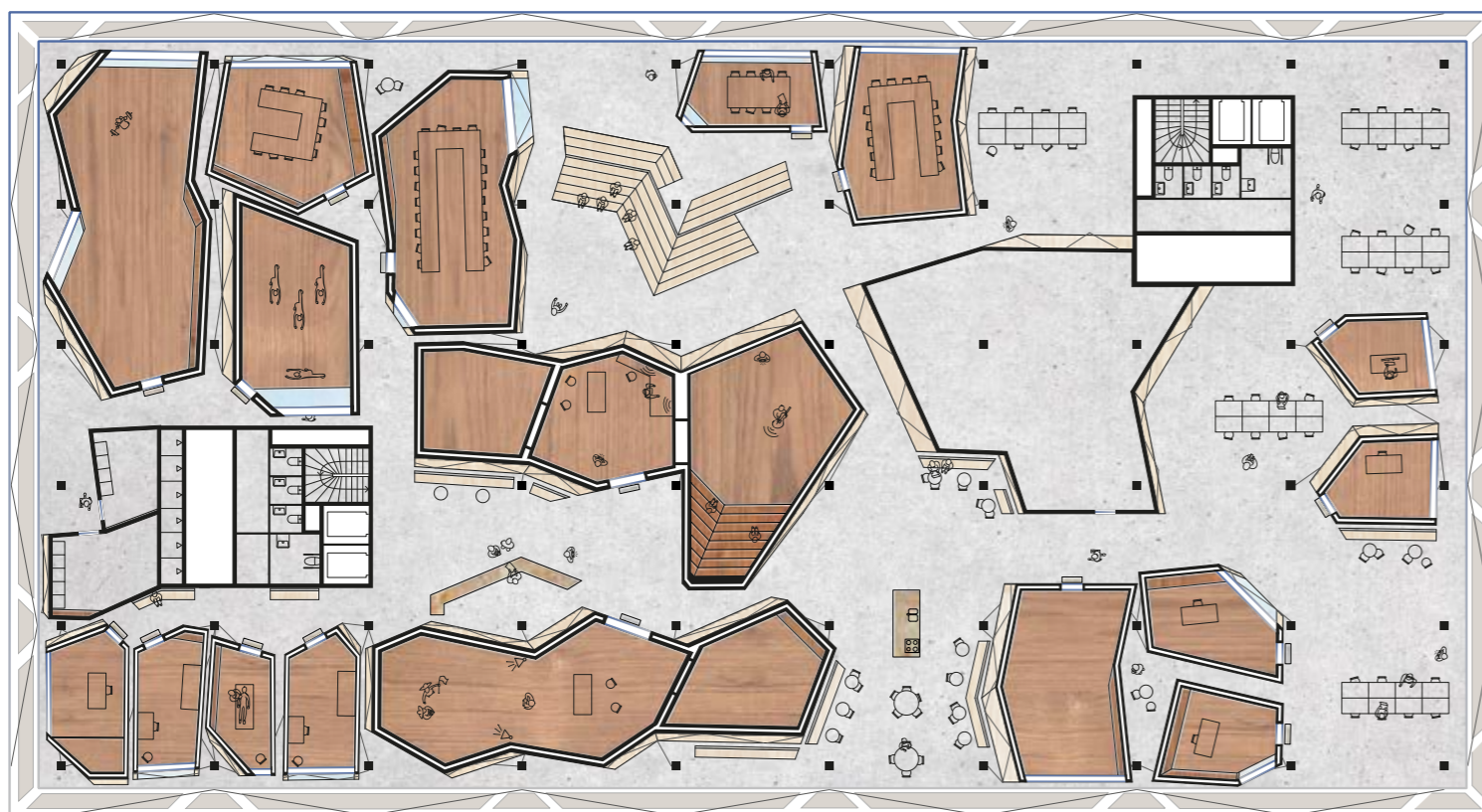
Planvy med genomskärning på 2 meters höjd för att betona de lutande väggarna.
