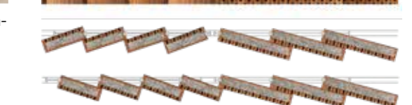
Vändbara paneler av trä och folietäckt hampa. En sida är lackerad för en reflekterande effekt och den andra är perforerad för absorption.
