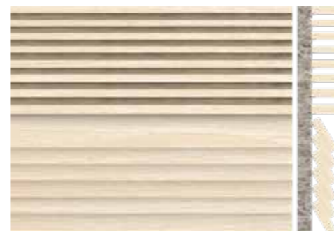
Vikbar träpanel framför absorberande hampafibrer täckta med en folie för att inte absorbera för mycket högfrekvent ljud.
