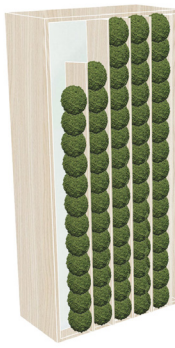
Solskärmningsmoduler med dubbelt glas och växter som renar tilluften
