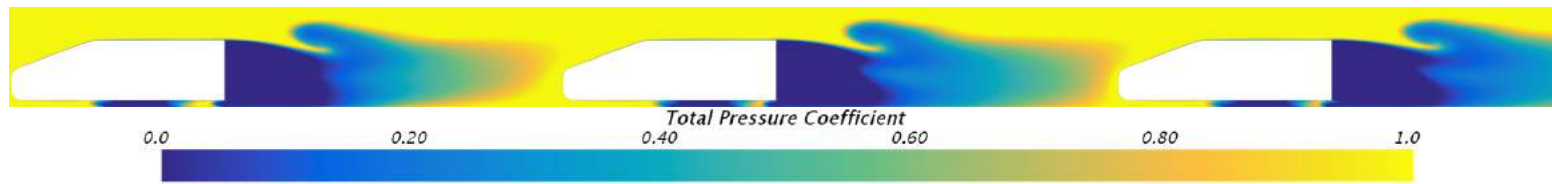
Figur B.38: Energin i flödet sett ifrån sidan. Avståndet mellan bilarna 5 meter och infallsvinkeln är 15 grader.
