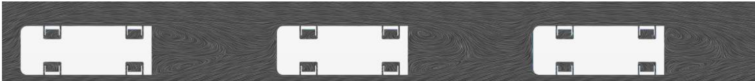
Figur B.19: Strömlinjer ovanifrån sett. Avståndet mellan bilarna är 3 meter och sidvindens infallsvinkel är 15 grader
