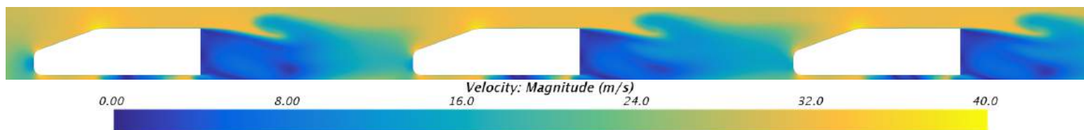
Figur B.26: Hastighetsfördelningen i systemet sett ifrån sidan. Avståndet mellan bilarna är 4 meter och sidvindens infallsvinkel är 7,5 grader.
