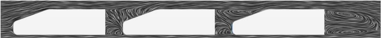
Figur 4.11: Strömlinjer sett från sidan för kolonnen där de interna avstånden är 0,2m. Vakens utseende varierar mellan de två ledande och det sista fordonet.
