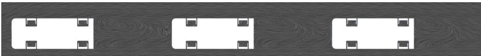
Figur B.22: Strömlinjer ovanifrån sett. Avståndet mellan bilarna är 3 meter och sidvindens infallsvinkel är 7,5 grader.
