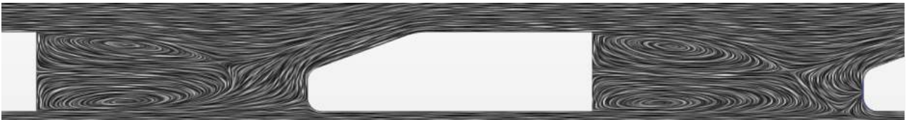
Figur 4.18: Strömlinjer sett genom bilens symmetriplan. Vaken uppvisar en symmetrisk karaktär kring basens vertikala centrallinje. Det observeras mindre störning i vaken från nästkommande fordon än tidigare och vaken liknar mer referensbilen. Strömlinjer sett från sidan för hela kolonnen återfinns i Appendix A.
