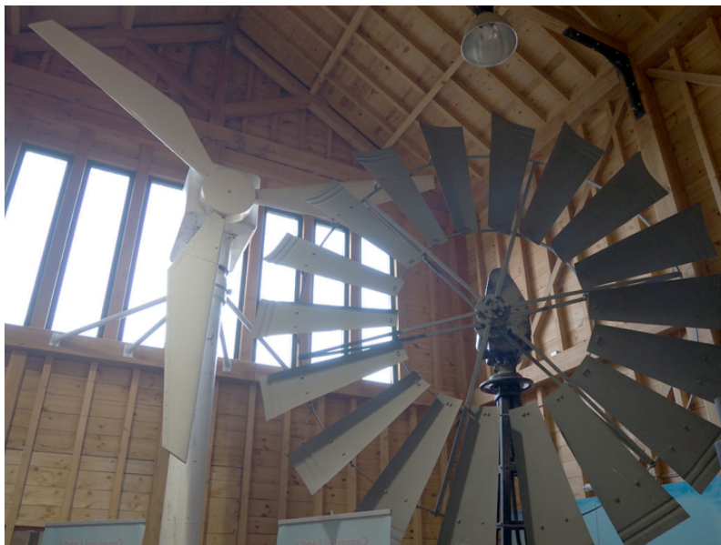
Figur 2.2: Två typer av HAWT. Från [1], omarbetad, CC-BY.
