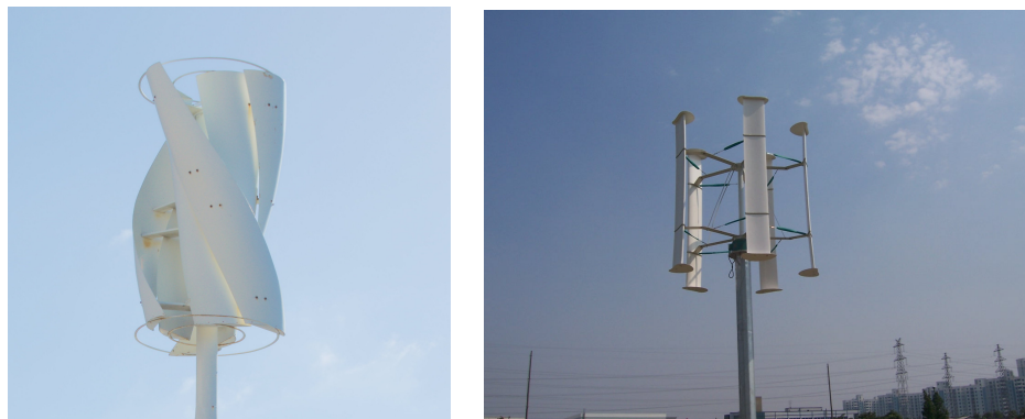
Figur 2.4: Vänster: VAWT av Savonius-typ. Från [2], CC-BY-SA. Höger: VAWT av Darrieus-typ. Från [3], CC0.
