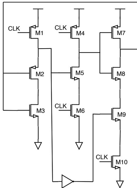
**Figure 2.7:** TSPC schematic 2
