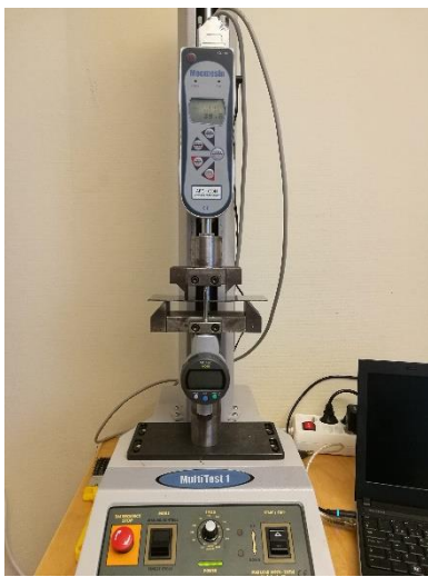
Figur 9-Fyrpunktsböjning hos Lamera AB
