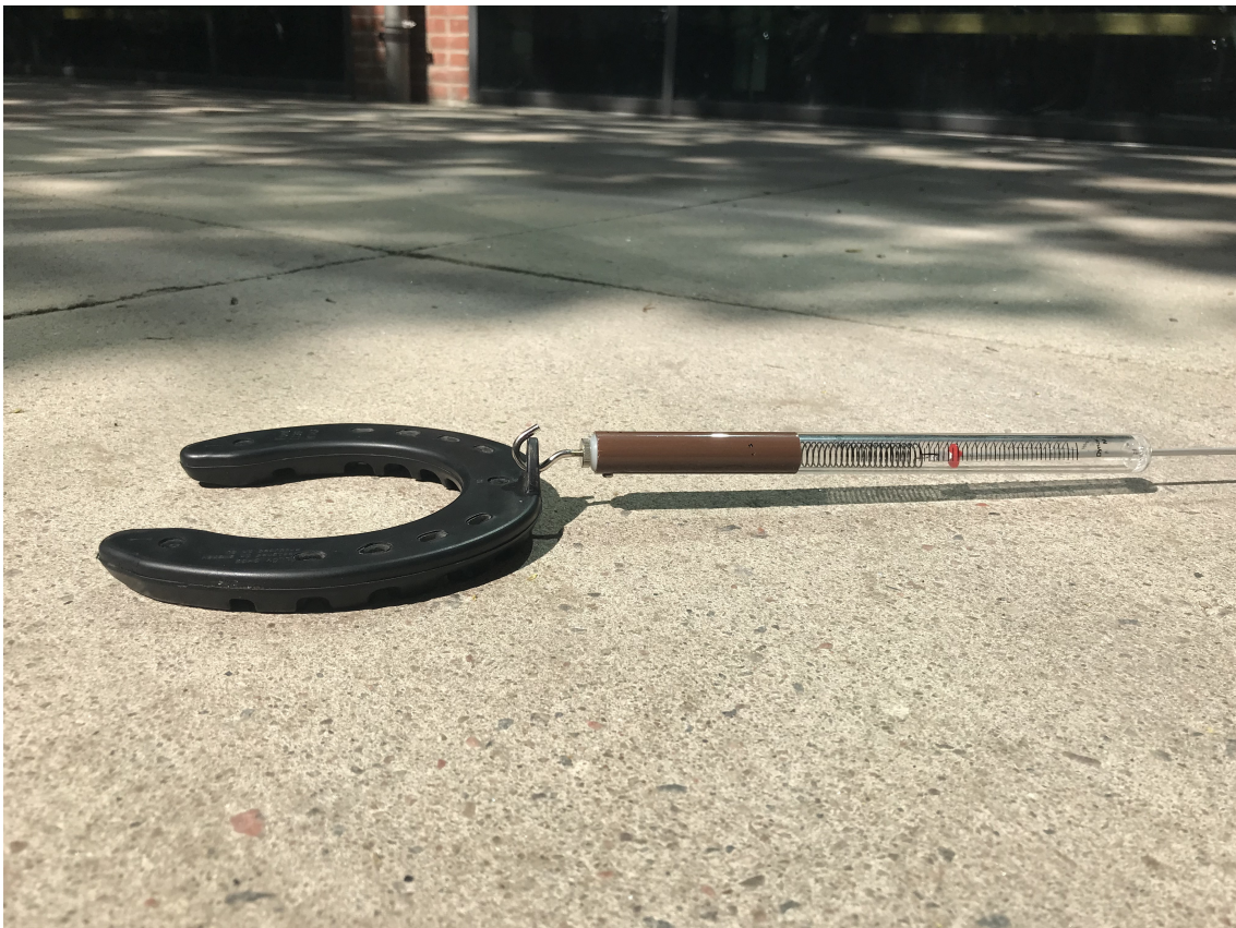
Figure 3.1: Öllöv SoftStep, friction test
