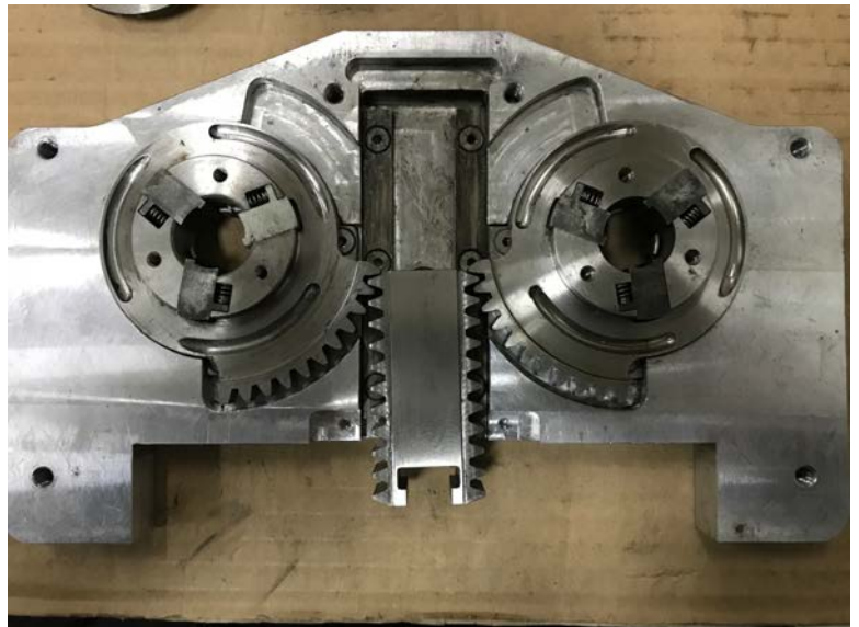
Figur 5, visar mekaniken kring avdragningsfunktionen inuti tip changer EC-6.
