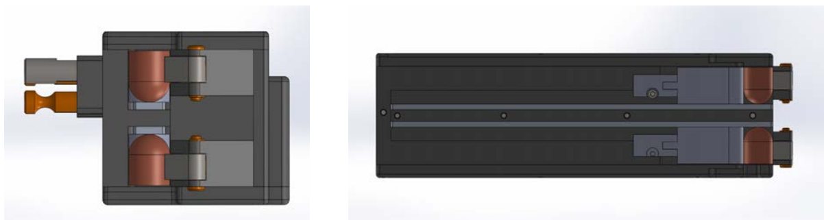
Figur 42, magasinet framifrån och från sidan med inställningar för 21 millimeters elektrodspestar.
