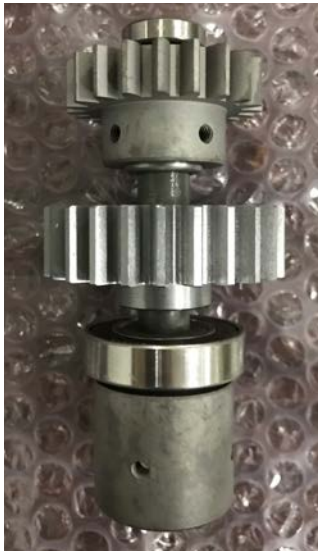
Figur 38, axeln som monteras på motoraxeln.
