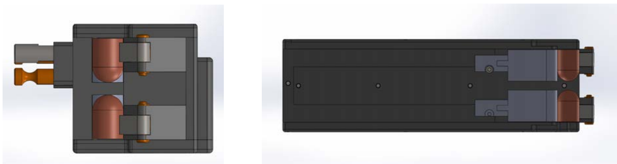
Figur 43, magasinet framifrån och från sidan med inställningar för 23 millimeters elektrodspestar.
