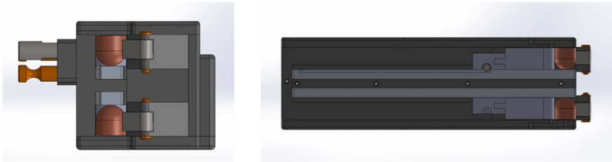
Figur 41, magasinet framifrån och från sidan med inställningar för 16 millimeters elektrodspestar.
