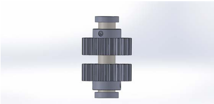
Figur 32, axeln mellan gradaren och motoraxeln.
