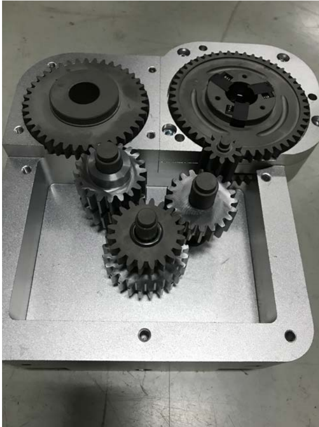
Figur 40, delsystem 1 monterat i övre och undre hölje.
