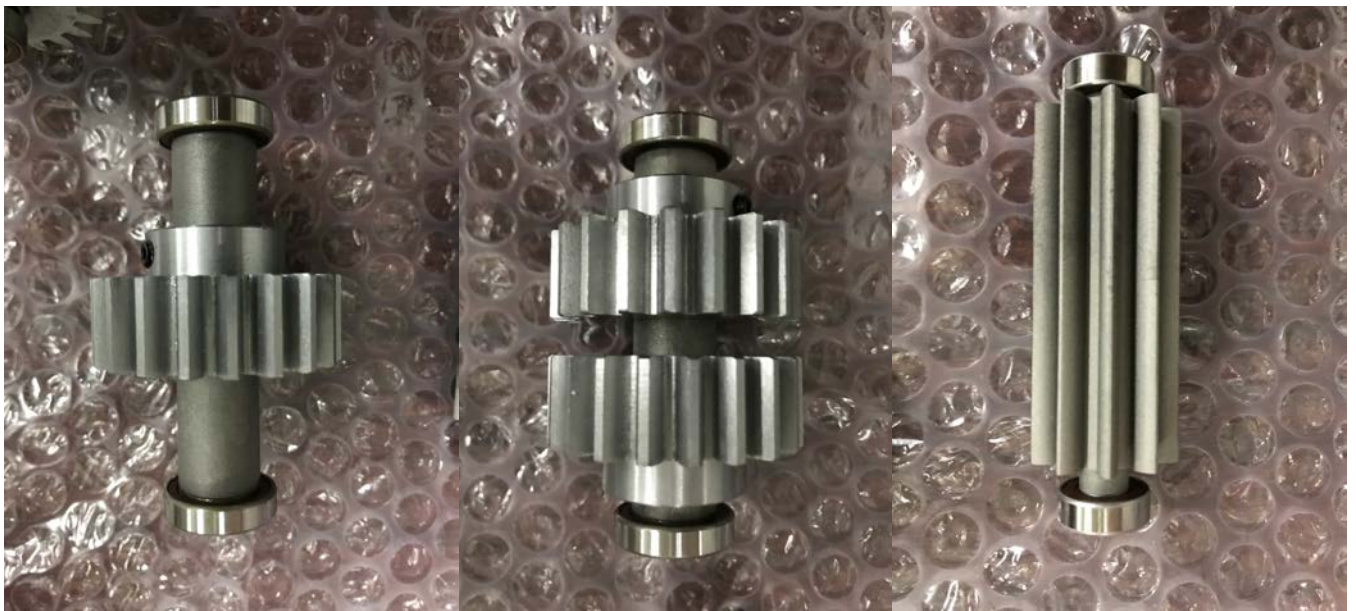
Figur 39, resterande axlar som tillverkades med sina respektive kugghjul och kullager.
