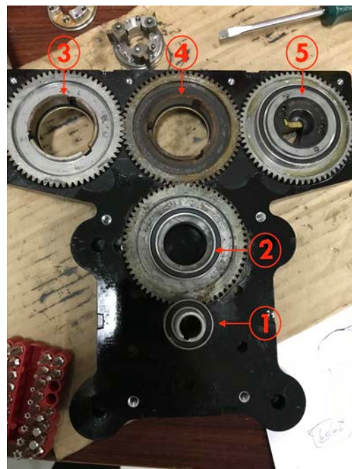
Figur 7, visar mekaniken för avdragaren och gradaren inuti produkten.
