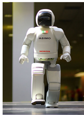
Figur 5: Den humanoida roboten Asimo som består av två armar och ben samt en torso [12]. Bilden är publicerad av CC BY-SA 3.0.
