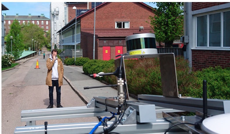
Figur 4.0.2: Testning av perceptionssystemet. Fotgängare placeras i lidarns synfält för att undersöka ifall perceptionssystemet fungerar. I förgrunden syns takplattformen med antenner och lidar.
