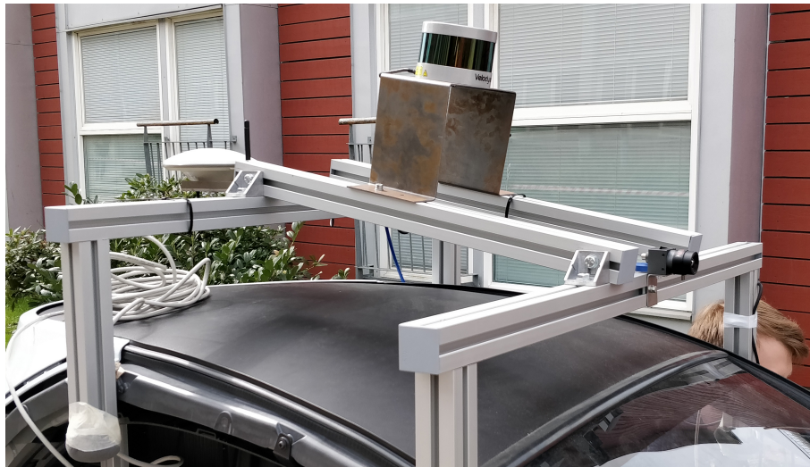
Figur 3.2.3: Takplattformen med monterade sensorer. Högst upp syns lidarn, i främre delen syns kameran och längst bak syns GNSS-antennen. Notera att plattformen är lutad ca 14^\circ
