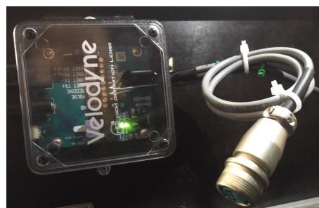
(b) Velodynes gränssnittslåda med den specialkonstruerade sladden inkopplad på kopplingsplinten.
