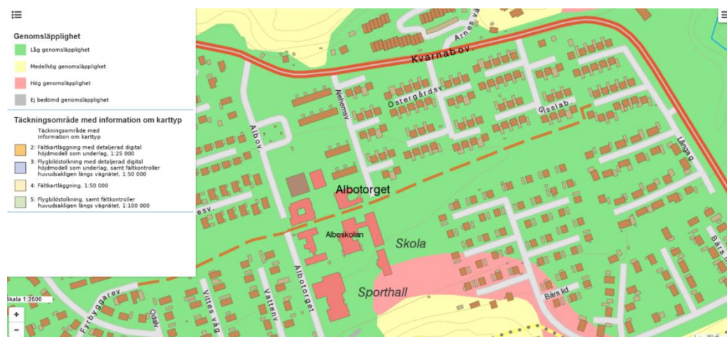
Figur 3 Genomsläppligheten i Skepplanda. Eftersom samhället ligger på lera går det här att tydligt se hur detta påverkar genomsläppligheten som är låg i hela de centrala delarna (SGU, u.å.).
