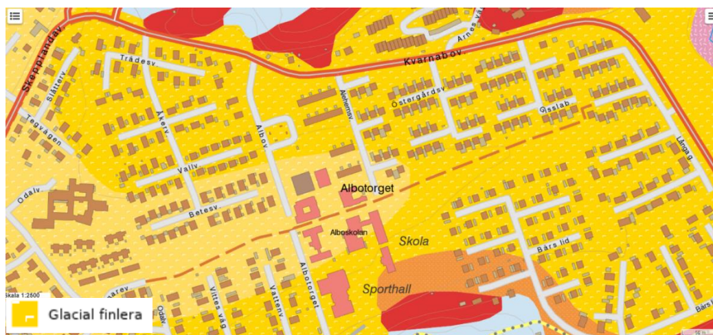
Figur 2 Jordarter i de centrala delarna av Skepplanda, det framgår att samhället ligger på lera (SGU, u.å.).
