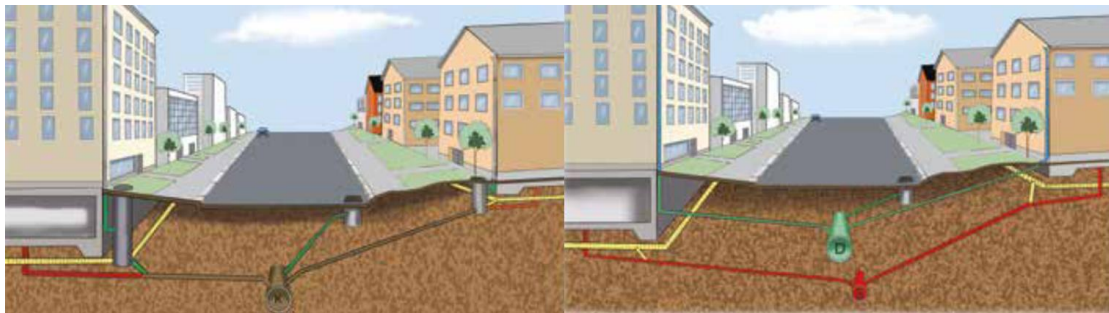
Figur 5 Till vänster visas ett kombinerat system där avlopps-, drän- och dagvatten leds bort genom samma ledning. Till höger syns ett separat system där drän- och avloppsvatten leds bort genom en ledning och dagvattnet genom en annan (Svenskt Vatten, 2016).
