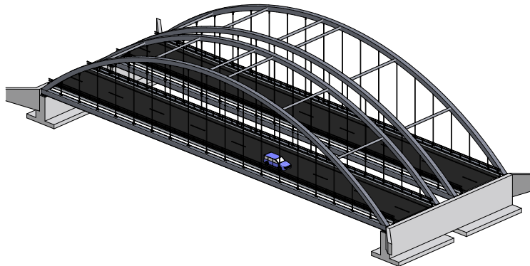
Figur 14.1: Bild på den preliminärdimensionerade bågbroen i stål
