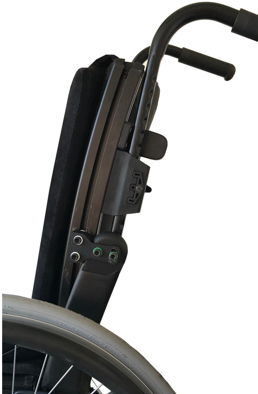
Bild 47. 3D printad prototyp av Axis, monterad på Cross 5.
