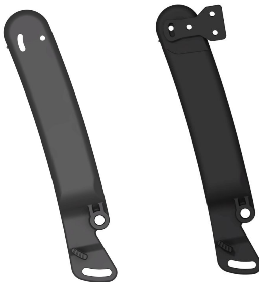
Bild 38. De olika förslagen med det cirkulära spåret i ryggchassit och det cirkulära spåret i brickan.
