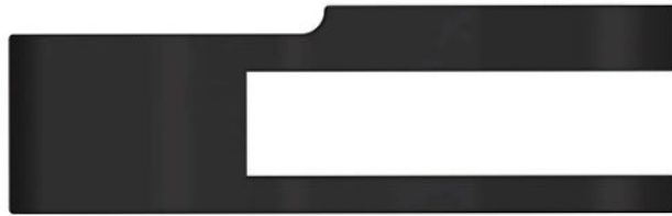
Bild 44. Kopplingsbrickan ovanifrån med urgröpning.
