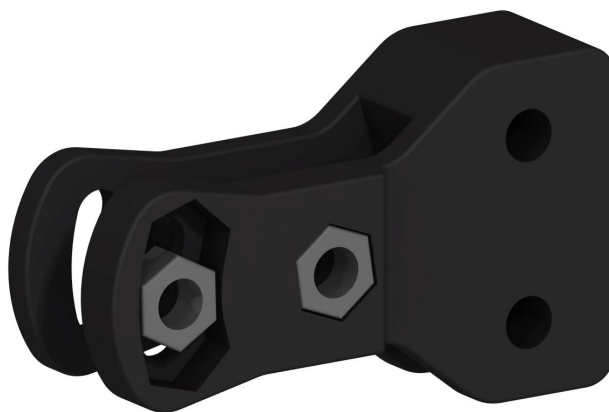
Bild 45. Kopplingsbrickan där de nedsänkta muttrarna visas.
