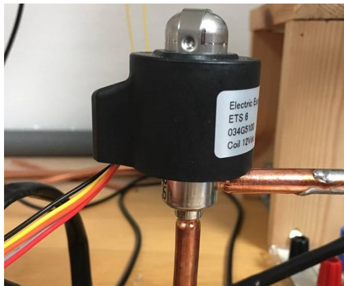
Figur 2.8: Den elektriska expansionsventilen ETS6-10 från Danfoss.
