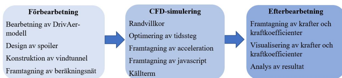
Figur 4.1: Flödesschema över arbetsgångens bestående av tre huvuddelar förbearbetning, CFD-simulering och efterbearbetning.
