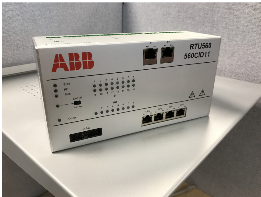
Figur 3.2: Figuren visar en ABB RTU560CID11, som är en mindre variant av en RTU.
