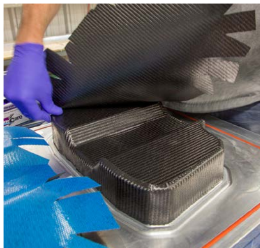
Figur 9 - Tunn kolfiberstruktur. Hämtat 2018-05-18 från http://www.innovativecomposite.com/what-is-carbon-fiber/
