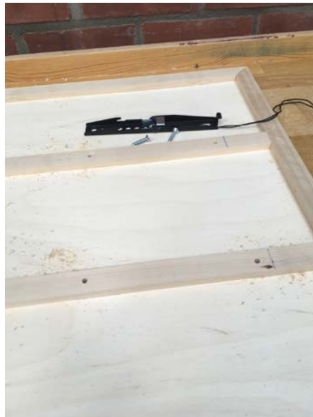
Figur 34 - Förborrning för infästning
