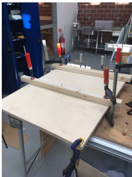
Figur 35 - limning av panelens andra sida
