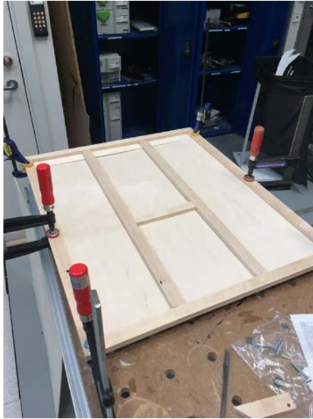
Figur 33 - Limning av ramverk och panelens sida
