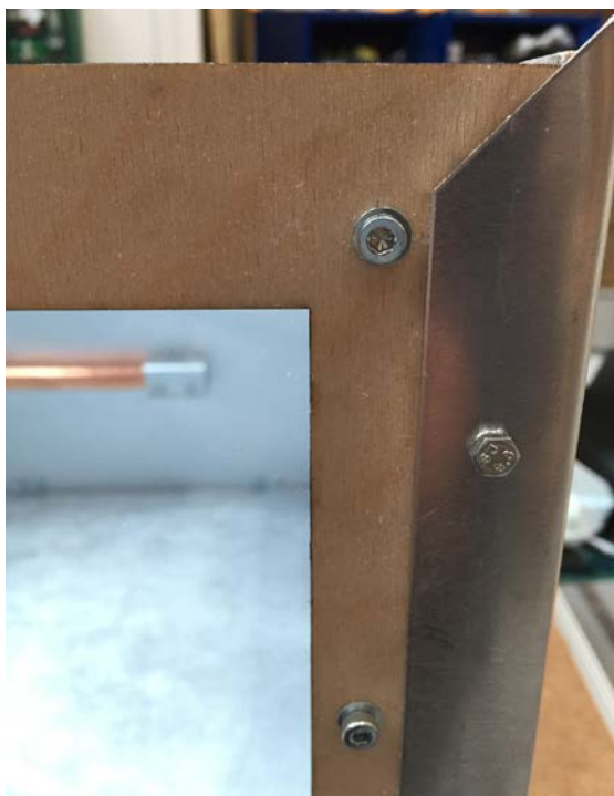
Figur 28 - Bild på skruvförband av ruta och chassi
