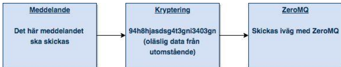
Figur 4.1: När ett meddelande skickas via ZeroMQ krypteras det först.
