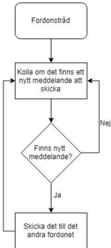
Figur 5.6: En REQ-tråd för varje fordon som det kommuniceras med.
