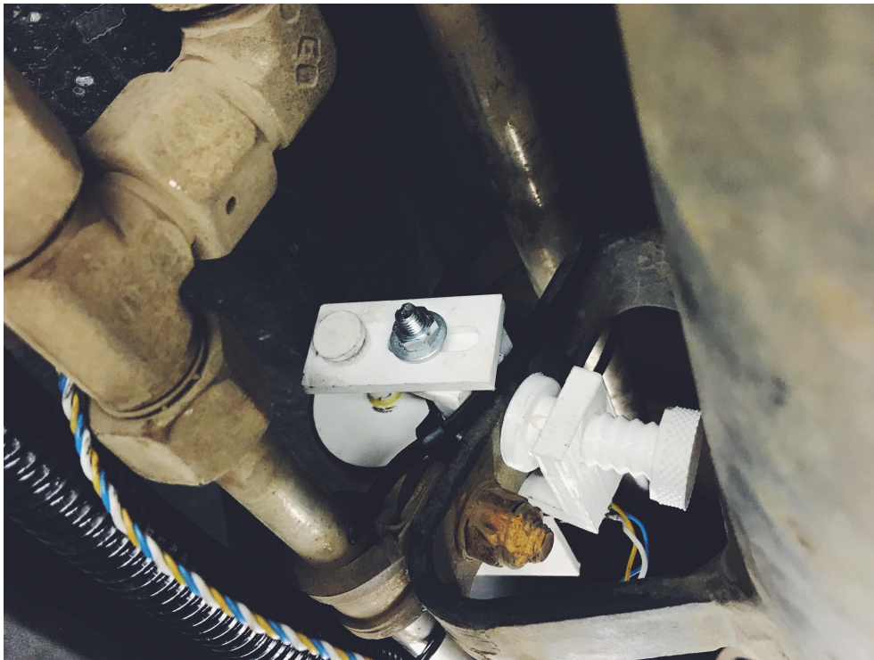
Figur 4.6: I figuren visas den initiala monteringen av hjulet på spårvagnen. Hjulet ligger rakt mot axeln.
