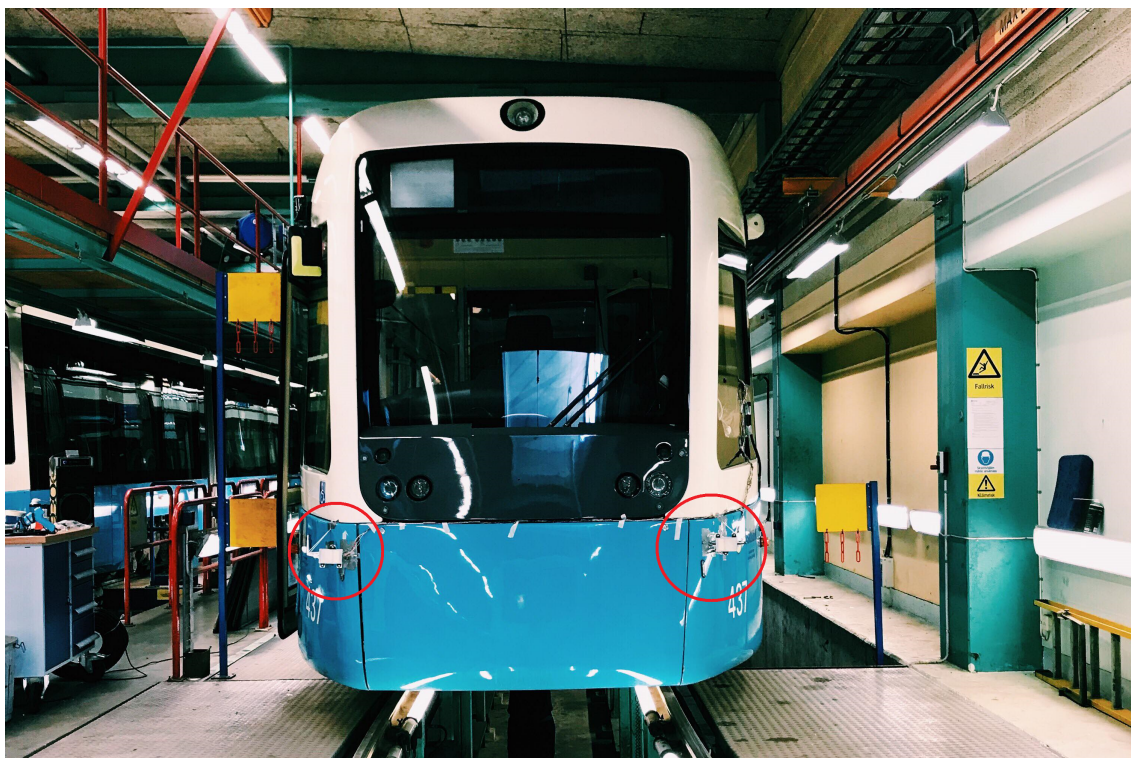
Figur 4.5: Radarsensorer monterade på spårvagn av typen M32.
