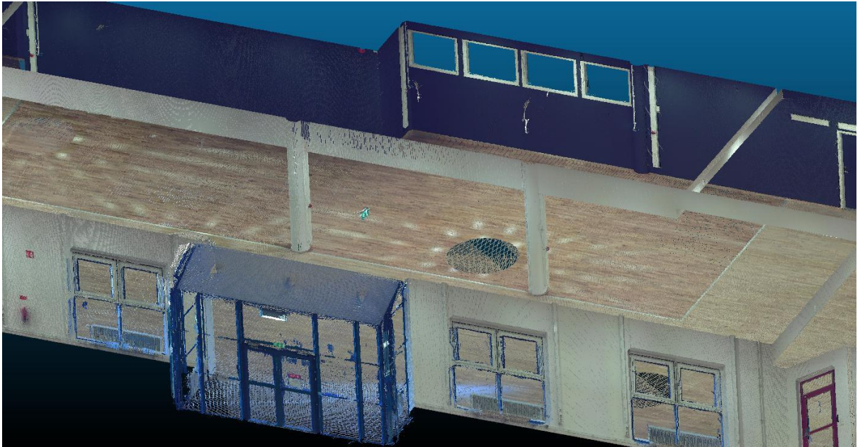
Figur 4.9: Närmare vy av uttunnat punktmoln från CloudCompare
