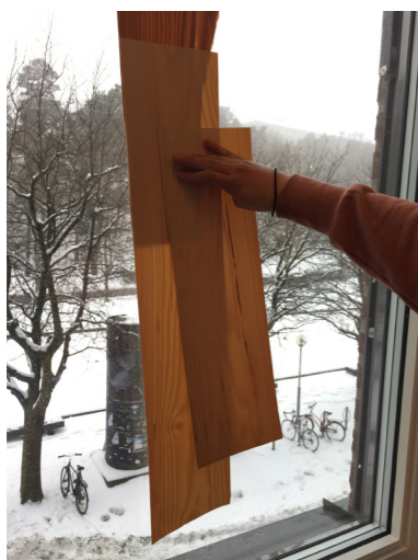
Test av solljusets effekt på olika många lager träfaner
