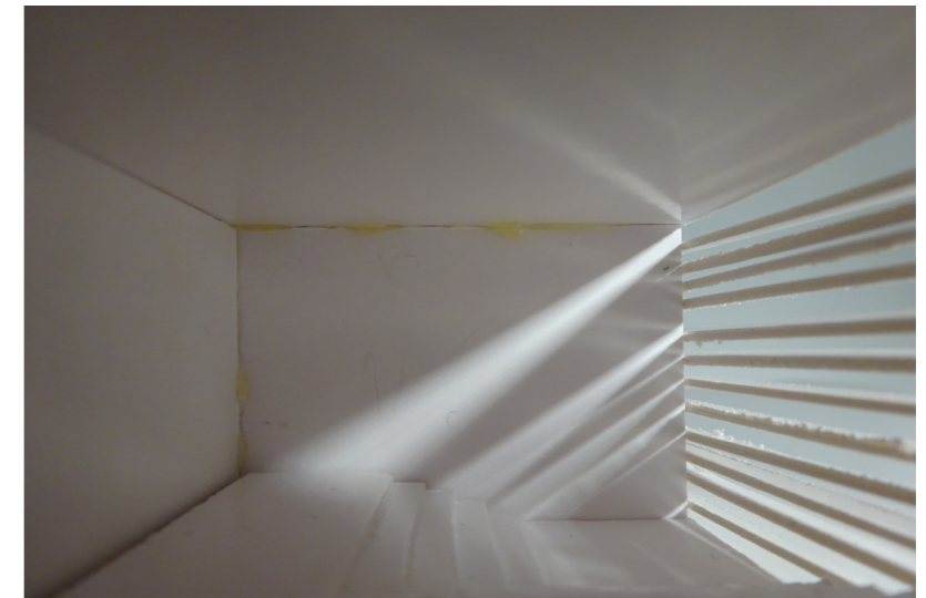
Raster med utforskning av ljus- kontra solljusinsläpp. Relationen mellan rastrets täthet och ribbornas dimensioner.
