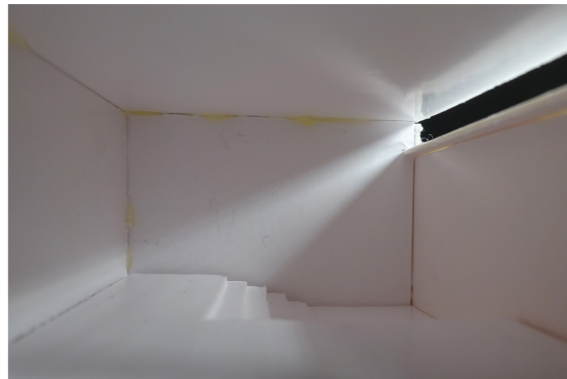
Ett fönsterband där solljuset reflekteras i en utkragande del för att skapa en ljusreflektion i taket och på så vis sprida ljuset.
