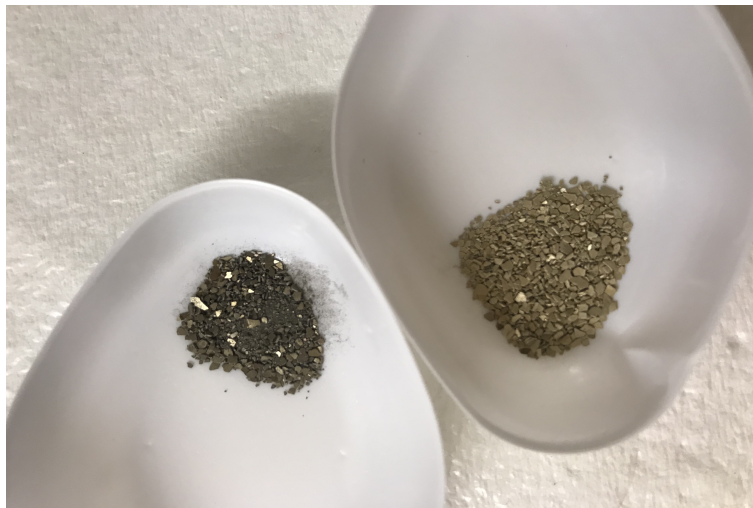
Figur 12: Till vänster är provet från nitreringsförsök 1 och till höger från nitreringsförsök 5. Provet från nitreringsförsök 5 är mer guldfärgat.
