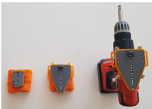
Figur 2.3: IR-trackers av två olika storlekar i två olika utföranden, på armband och verktyg
