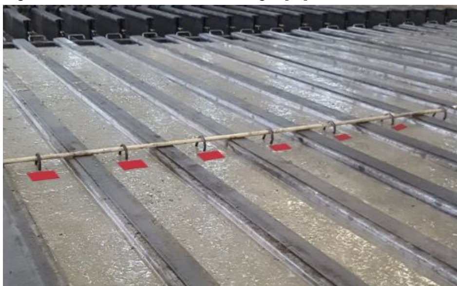
Fig. 9.6. Ett förslag på hur det kan se ut med klisterlappar på pålarna som visionsystemet kan lokalisera.
