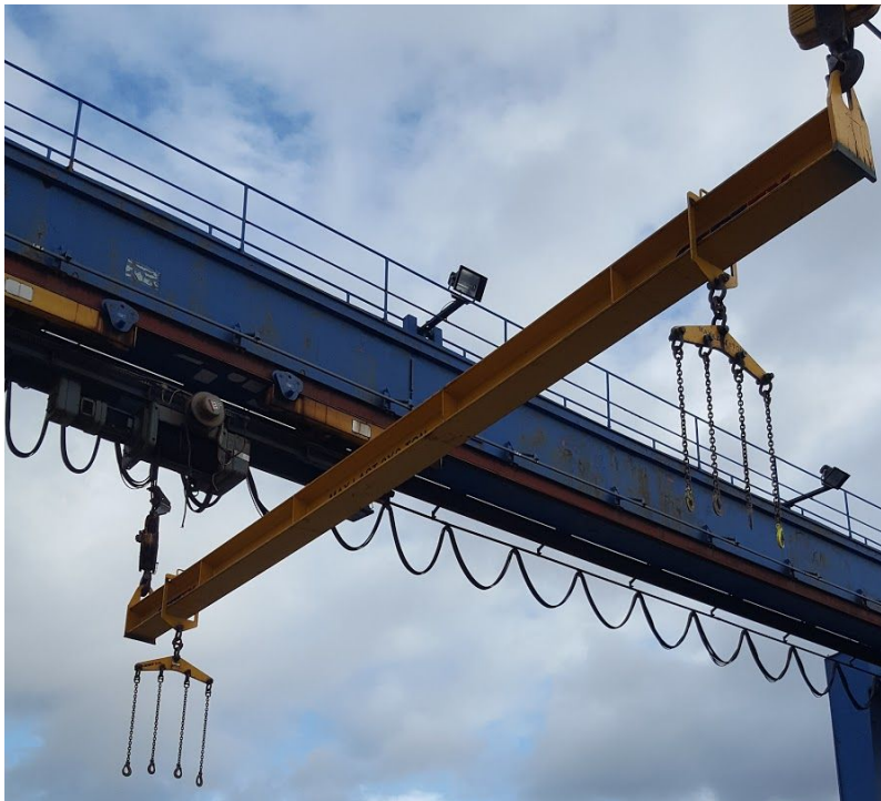
Fig. 2.5. Skanskas lyftok som höjer/sänker pålarna och flyttar dem i sidled.
