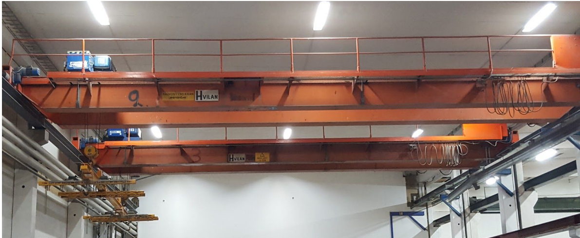
Fig 9.1. Traversbalkarna i taket på Skanskas inomhusanläggning, lyftoket placeras mellan två traversbalkar och visionsystemets kameror placeras exempelvis på lyftoket.
