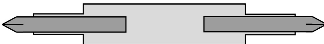
Figur 1.2. Exempel på en isolerande skruvmejsel i genomskärning. Ljusgrått parti representerar material som saknar ledningsförmåga. Mörkgrått parti indikerar material med god konduktivitet.
