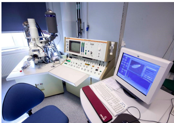
Figur 3.5: Jeol JXA 840A svepelektronmikroskop
