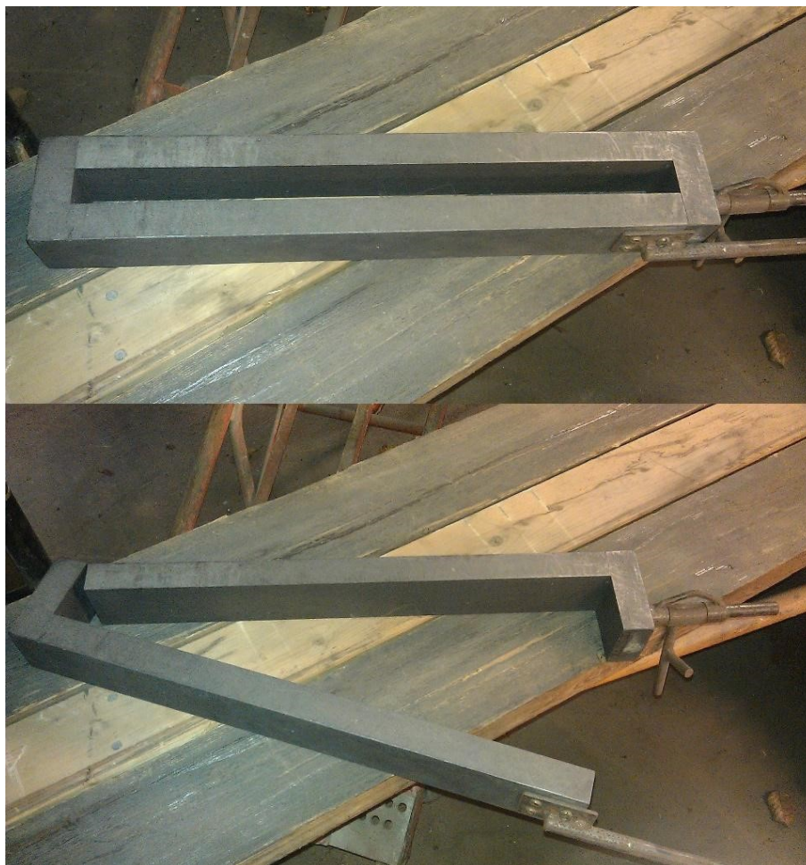
Figur 3.1: Form som användes vid gjutning av glas
