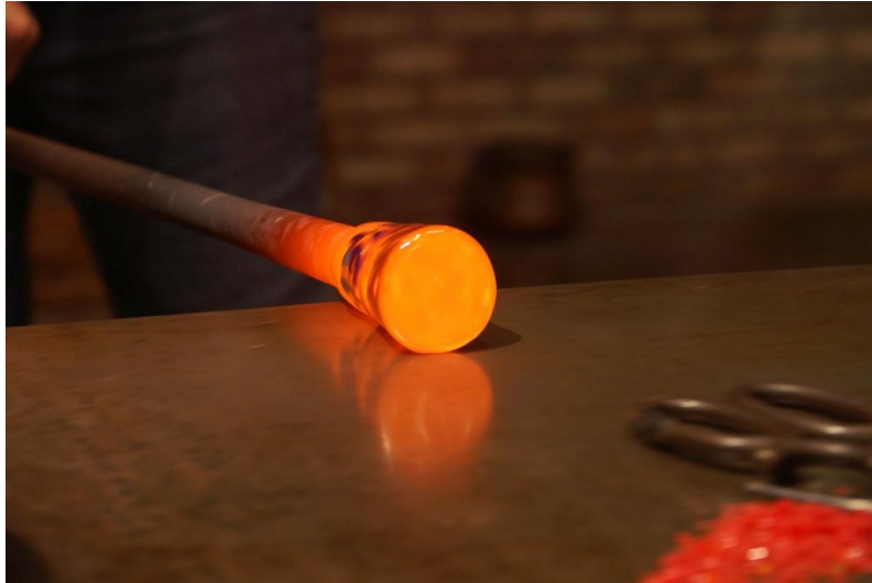
Figur 2.4: Välsning av glas på välsbläck[1]
