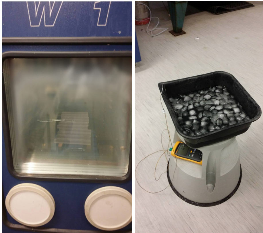
Figur 3.8: Till vänster det klimatskåp som användes och till höger det isbad stavarna doppades i
