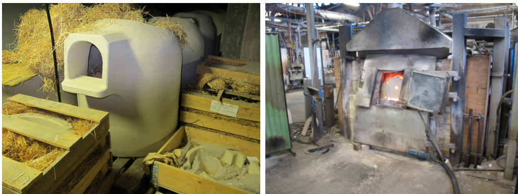
Figur 2.3: Till vänster en ny degel och till höger en degel i användning i en ugn
