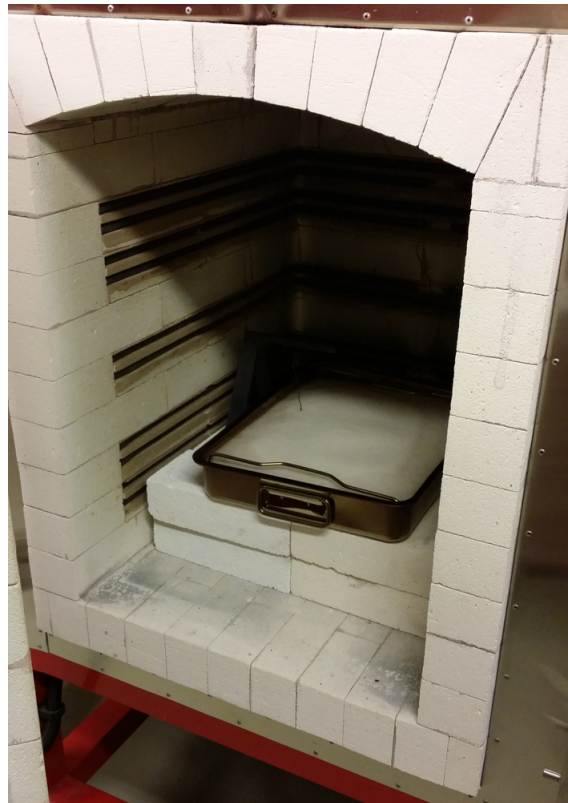
Figur 3.3: Fylld saltform i ugnen
