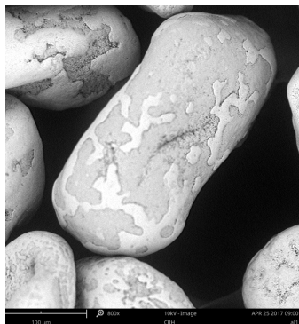
(b) Använd ilmenit som lakats med vatten i 24 h. ( 100\ \mu\text{m} )
