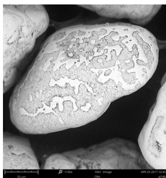
(e) Använd ilmenit som lakats med vatten i 80^{\circ}\text{C} i 24 h. ( 50\ \mu\text{m} )
