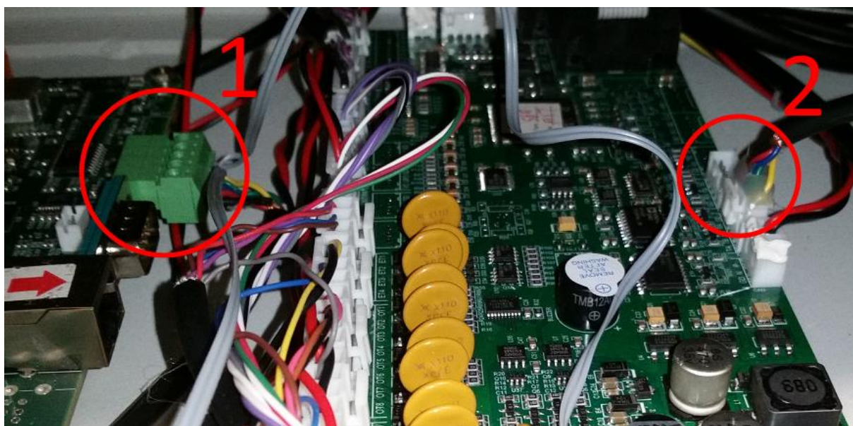
Fig 5.1.1: Till vänster sitter kortet med operativsystemet och dess anslutning (1) och till höger styrkortet och dess anslutning (2).
