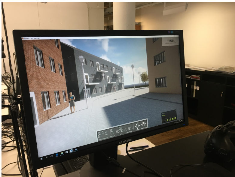
Figur 5 Denna vy kan både ses som en animerad film och en virtuell miljö då båda ses på storbild. Skillnaden är att den animerade filmen är förinställd eller styrs av presentatören och den virtuella miljön ger möjlighet till att själv manövrera runt på skärmen.
