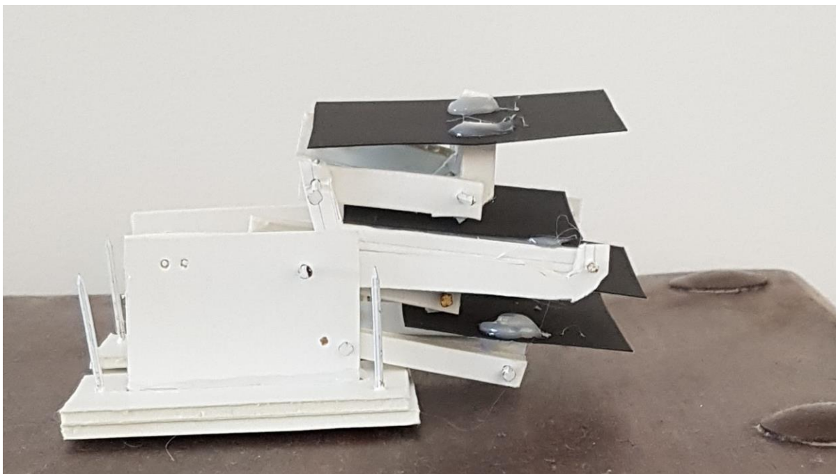
Figur 19. Här är en annan bild på prototypen där konceptet är i ett hopfällt läge för att testa mekanismerna och dess flexibilitet samt kompressionsförmåga (Författarnas egen bild).
