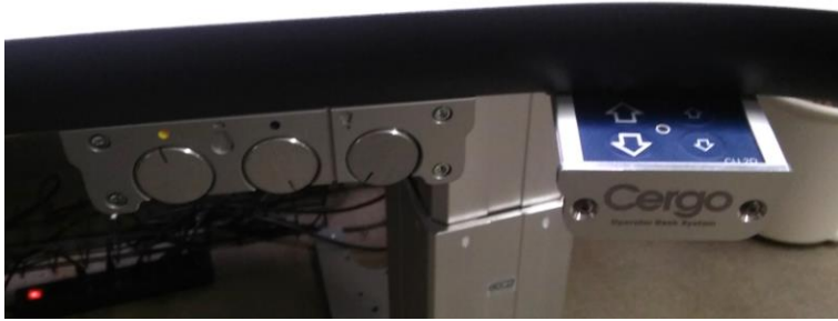
Figur 3: Kontrollpanel för ljusinställningar och höj- och sänkbarhet. Författarens egen bild.
