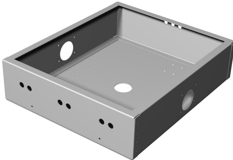
Figur 3.2: CAD-modell av konstruktionsplåtarna ihopmonterade
