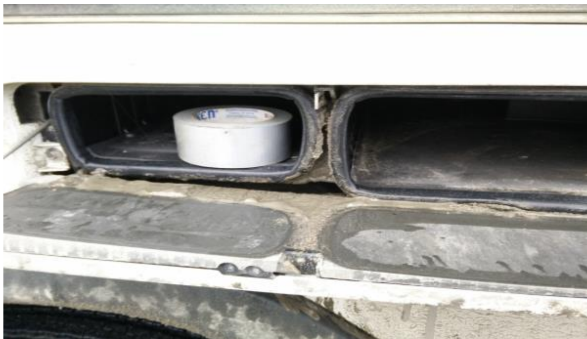
Figur 2.3. Smuts som har lagts sig på locket och kring tätningen efter användning av Second Storage.
