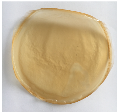
Figur 14: Bild av en film bestående av AX, HBAX och CNC_{but} med sammansättningen 90:9:1.
