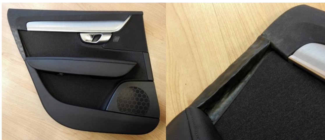
Figur 8.11. Bild på koncept D i sin helhet med carry over från originalpanelen. Författarnas egen bild.
