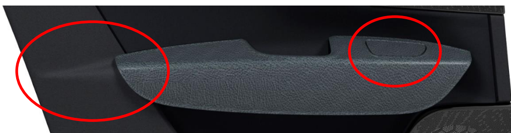
Figur 9.4. Illustration av armstödet med dess mjuka påbyggnad på ramen till vänster samt den övertäcka knappsatsen till höger, båda markerade med cirklar.
