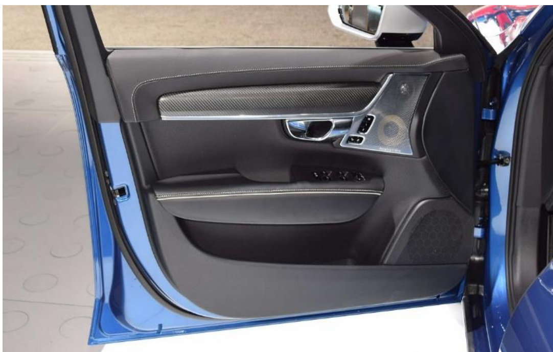
Figur 4.7. Volvo V90 framdörrspanel med det exklusiva diskant högtalargallret av märket Bowers & Wilkins (A2mac1, 2016).
