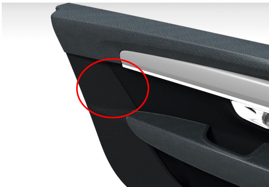
Figur 9.3. Illustration och markering som visar den mjuka övergången mellan carry over och ram.
