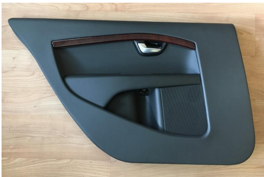
Figur 2.2. Frontvy på bakdörrspanelen till V70 limousine, förlängning i framkant (till höger i bild) och formanpassning i bakkant (till vänster i bild). Författarnas egen bild.
