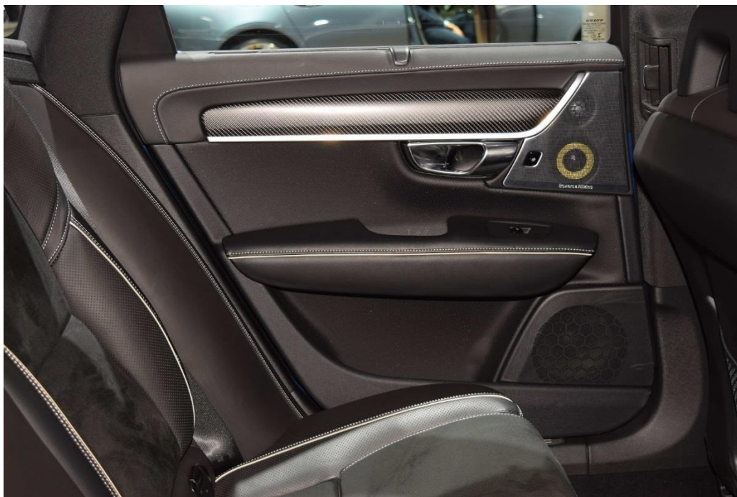
Figur 1.3. Bakdörrspanelen hos en Volvo V90 som i detta projekt ska omkonstrueras för att kunna återanvändas som mittdörr i Volvo S90 limousine (A2mac1, 2016).
