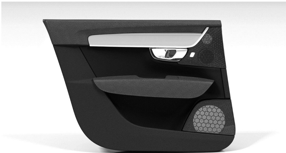
Figur 9.1. Den nyframtagna limousinepanelen renderad i Catia V5.
