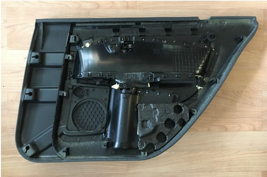
Figur 2.3. Rekonstruerad dörrpanel med tydlig övergång från originalpanelen och förlängningen. Författarnas egen bild.
