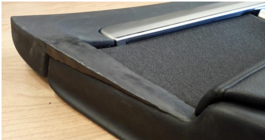
Figur 8.10. Detaljerad vy över koncept C och mötet mellan ramen och carry overn, förändringen gestaltad i lera. Författarnas egen bild.
