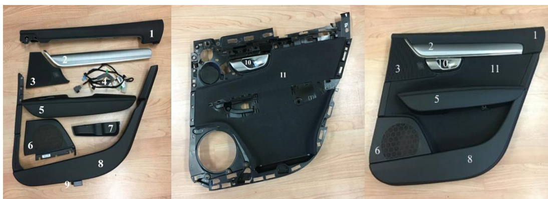
Figur 4.3. Demonterade komponenter 1-9 från Volvo V90 bakdörrspanel.
