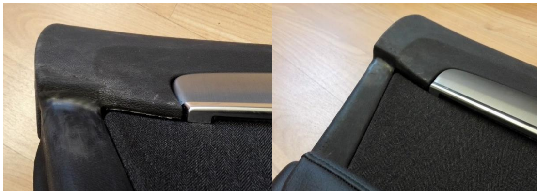
Figur 8.3. Koncept A i närbild. Här ses komponentens övergång i djupled och hur waist rail och nedre ram sammanfogats till en del. Författarnas egen bild.
