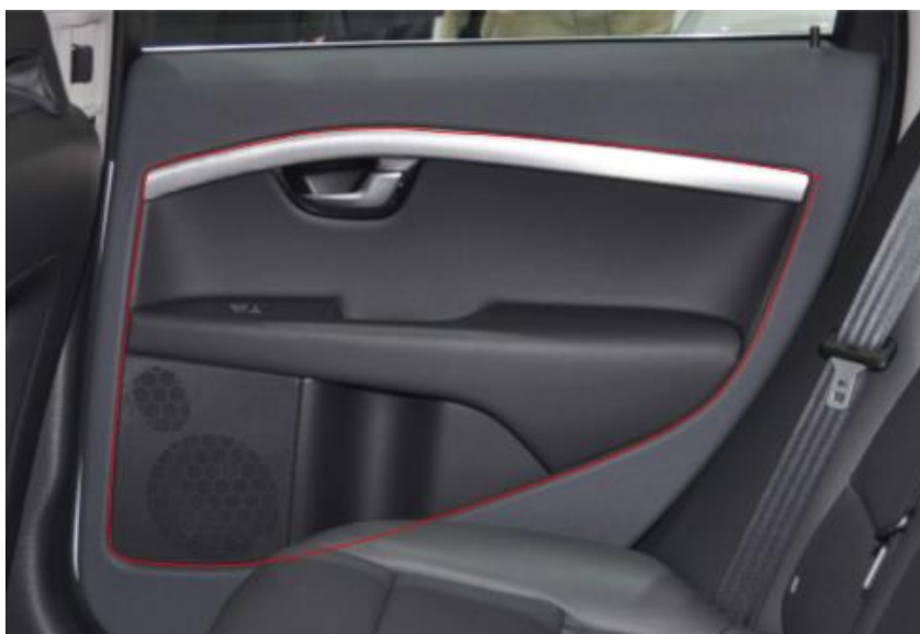
Figur 2.1. Volvo V70 bakdörrspanel i svart utförande med carry overn inom det rödmarkerade området (A2mac1, 2010).
