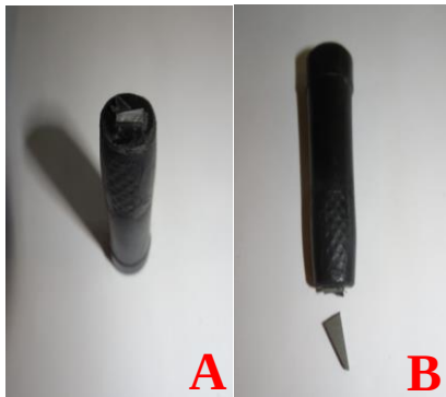
Figur 4.17. SkiGo Pro vid slag från sidan där a) brott vid infästningen skedde och b) lite längre ned på metallspetsen
