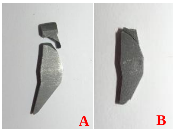
Figur 4.16.a) Swix brott vid slag framifrån på spets tippen, b) slag på mitten-området
