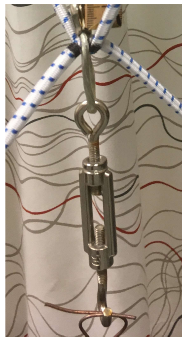
Figur A-6 – Foto över krok för påhängning av vikter.
