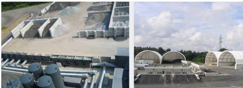
Figur 3.9 Ett tyskt asfaltverk (Benninghoven, 2017). Den nedre bilden visar hur Tyskland delar upp stenfraktionerna och skyddar dem från regn.
