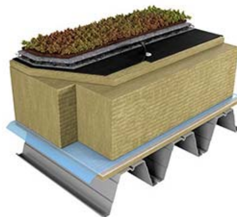
Figur 18 Exempel på ett grönt industritak med underlag av plåt.
