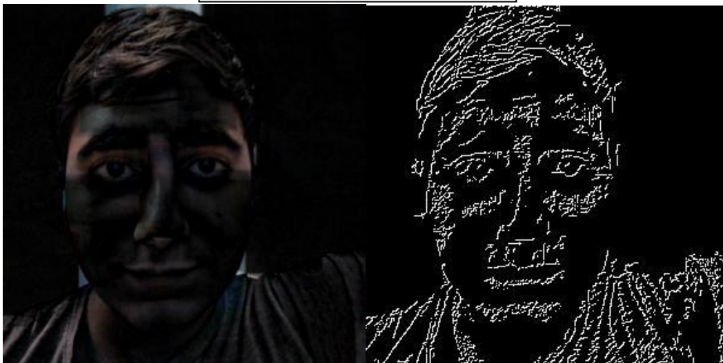
Figur 4.2.2.8: Resultatet från att först använda top-hat transform och vidare applicera edge detection.
