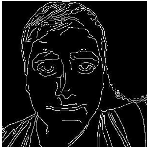
Figur 4.2.2.4: Resultatet från att först ta bort bakgrunden för bilden och sedan applicera edge detection.
