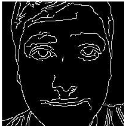
Figur 4.2.2.3: Resultat från att först identifiera ansiktet i bild och ta bort resterande bildelement, för att vidare utföra edge detection.
