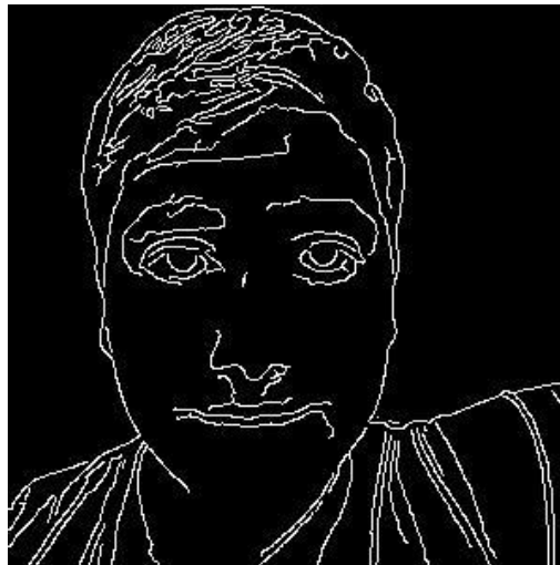
Figur 4.2.2.1: Resultat från bildbehandling av originalbilden med enbart Mathematica funktion för edge detection.
