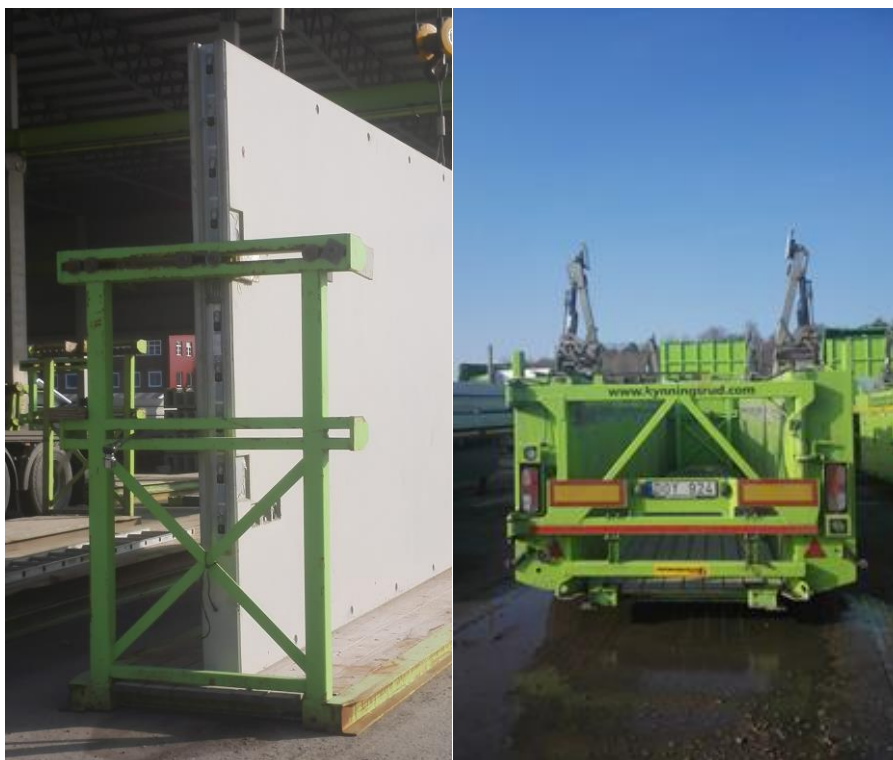
Figur 4.4.2 - 4.4.3: t.v: Vagg placerad i kassett. t.h: Armar som låser fast kassetten.
