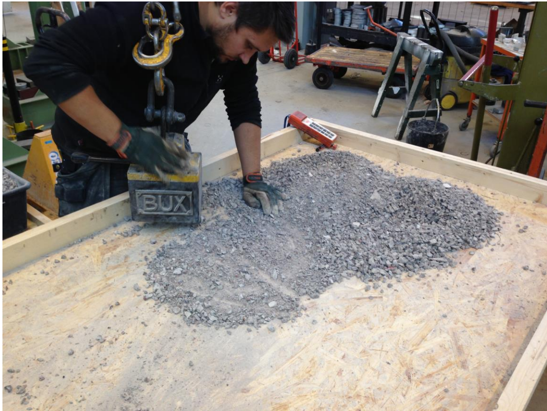
Figur 4.12 Uppsamling av fibrer med hjälp av en magnet
