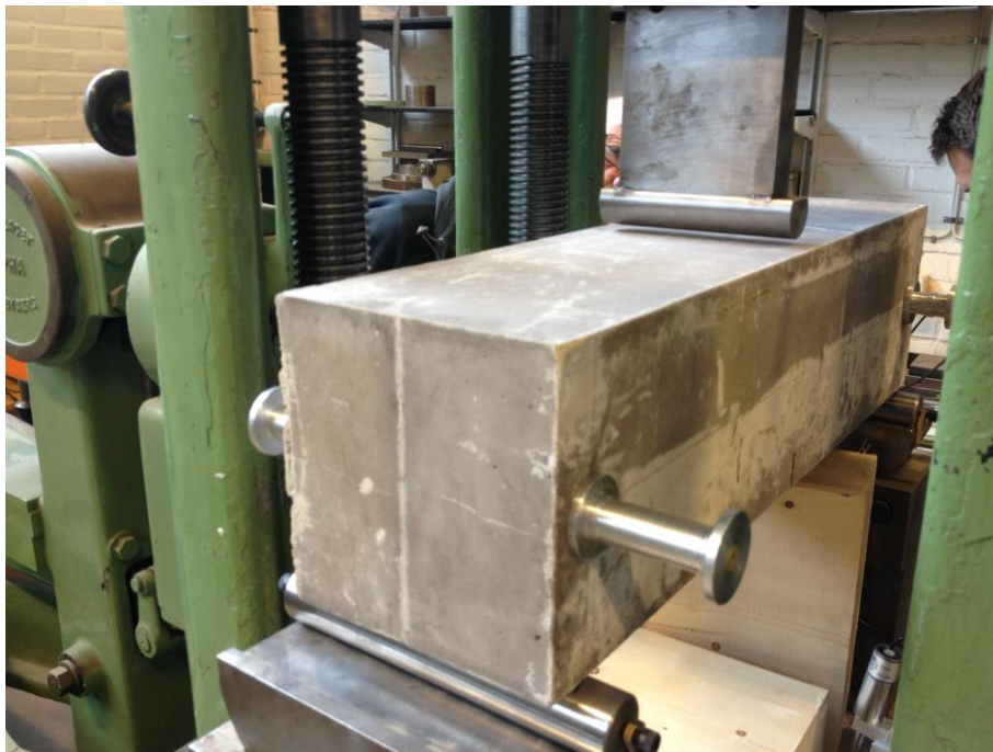
Figur 4.7 En provkropp är placerad i riggen, med stöd för nivågivare (LVDT).
