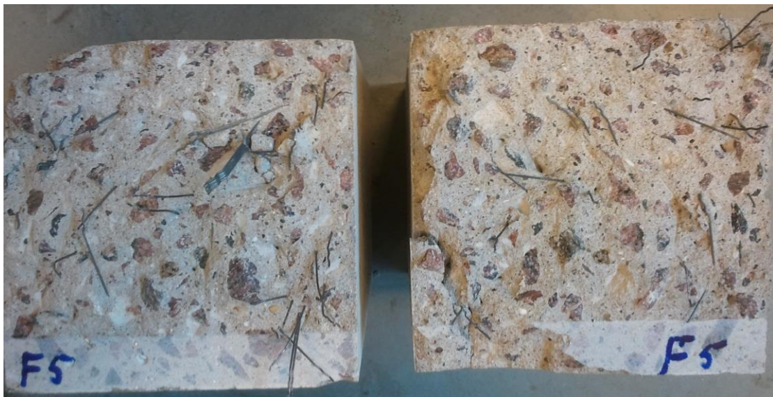
Figur 4.11 Snittytans utseende efter utfört experiment för balk F5
