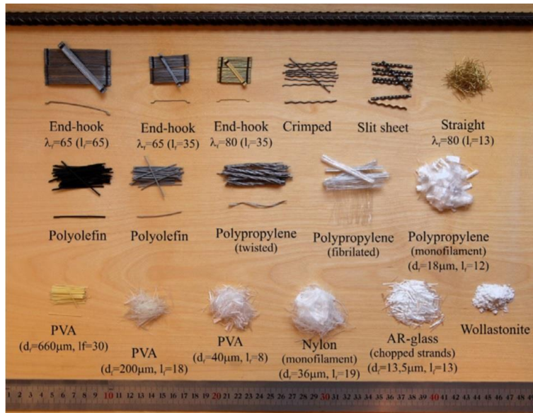
Figur 2.1 Exempel på fibrer, Färdig betong (2007).
