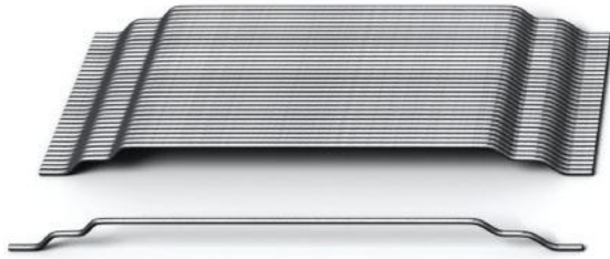
Figur 2.3 Fibern Dramix D5 som vi använde i experimentet.
