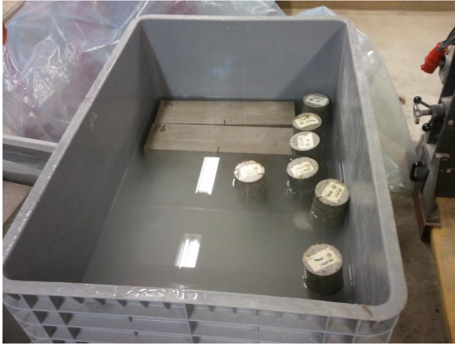
Figur 4.2 Provkropparna placerade i vattenbad.
