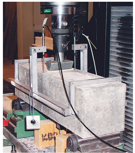
Figur 6a (tv): Beskrivning av enaxiellt dragförsök och (b) trepunktsböjning enligt Rilem TC 162-TDF.
