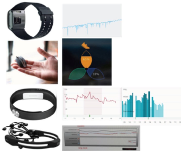
Figur 1: De fyra teknikerna som testades i projektet DIG IN ovanifrån: 1. Aktivitetsarmband (Empatica), 2. Andningsfrekvensmätare, 3. Hjärtfrekvensarmband (Sony), 4. Hjärnaktivitet (EPOC+) 1
