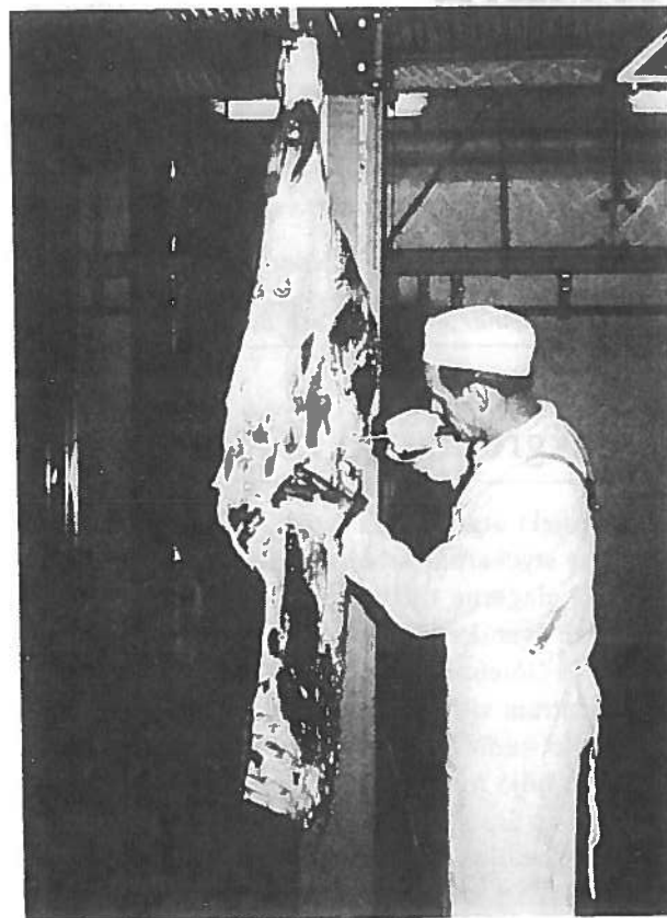
Figur 1. Med en rörlig köttkrok kan arbetshöjden anpassas individuellt till styckarens kroppsmått och till de olika arbetsmomenten.
