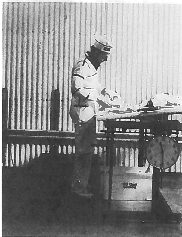
Figur 4c. En bordsskiva som lutar 4 – 8^\circ ger ett bättre synavstånd för stycken som ligger längre bort på bordet och bidrar till att nacken kan rätas upp. Lämplig bordshöjd vid fläskstyckning är 17–22 cm under armbågshöjd.
