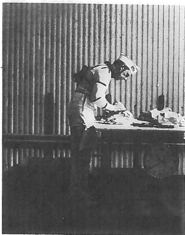
Figur 4a. Ett för lågt bord innebär att styckaren måste böja sig fram med en ökad belastning på ryggen.
