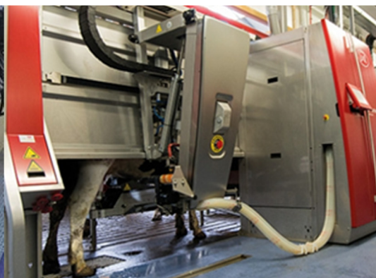
Figur 2: Robotmjölkning. Korna går till en robotmjölkstation vid behov. Mjölkning sker i snitt 2.5 gånger per dag (Wedholms AB)
