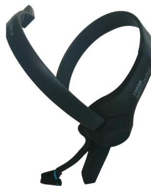
Figur 2.2: NeuroSky MindWave Mobile. Författarnas egen bild.
